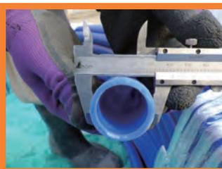
掘削孔に差し込む地中熱交換パイプ(Uチューブ)です
